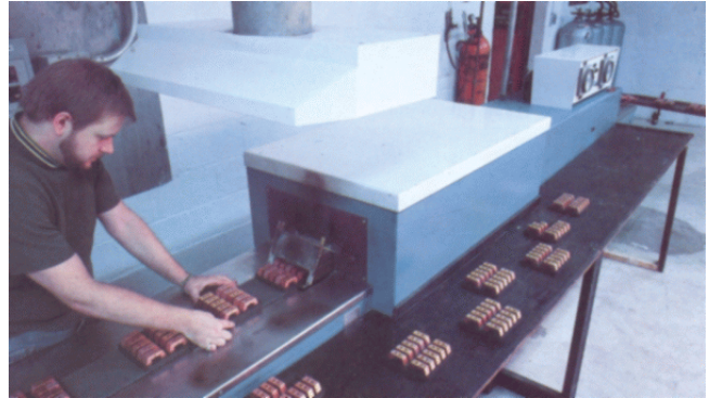
figuur 2.6 Ovensolderen (foto Handy & Harman)
