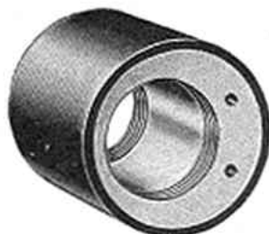
14131 - Bussola movimento per tandem da saldare al telaio, con eccentrico in dural. filettato per calotte da mm. 36
