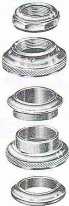
10324 - Serie sterzo tipo THOMPSON pesante per ciclotrasporto e micromotori per canotto mm. 25.4 - sfere 3/16.
