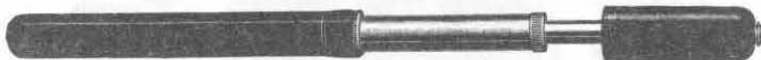
Nr. 3458. Teleskopluftpumpe aus Zelluloid , 3teilig. Diese Pumpe ist aus schwarzem Zelluloid in Verbindung mit Messingrohren gearbeitet und eignet sich vorzüglich für die Satteltasche. Der Pumpenschlauch ist am Handgriff einschraubbar. 23 mm Rohrdurchmesser oben, geschlossen 190 mm, ausgezogen 440 mm lang. Hierzu paßt Pumpenschlauch Nr. 1617. Stück Mk. 1.10
