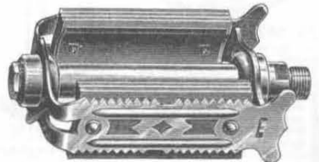
Nr. 3472. Extra breites, doppelstausicheres Gummiflügelpedal, welches infolge der stabilen Ausführung als Tourenpedal besonders zu empfehlen ist. Dasselbe hat auf der Achse eine besondere Staubkapsel, wodurch größtmögliche Staubsicherheit erreicht wird. Die Konusse und Achsen sind best gehärtet, sauber und exakt gearbeitet, in fein vernickelter Ausführung. Zum Einschrauben, mit Rechts- und Linksgewinde. Paar Mk. 2.30
