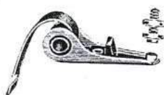
3623. Coppia contatti per magnete micromotore Mosquito 1ª serie.
