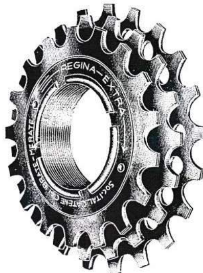
2755. Ruota libera Regina Gran Sport tripla 1/2 \times 1/8 , dentature diverse, per cambi con tenditore a molla.
