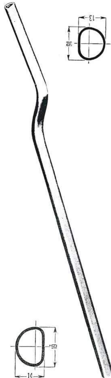
3244. Tubi posteriori verticali P 4 , tipo Maino piegati, sezione a D .
