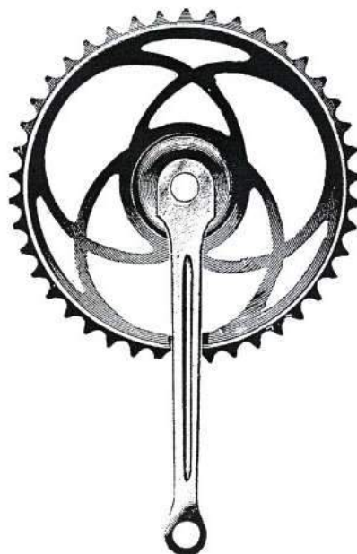
1954. Guarnitura W.A. pressata per carter, 42 denti 1/2 \times 1/8 , cromata.
