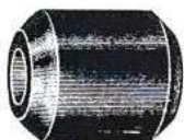
3680. Tampone inferiore dell'ammortizzatore idraulico scooter Vespa.
