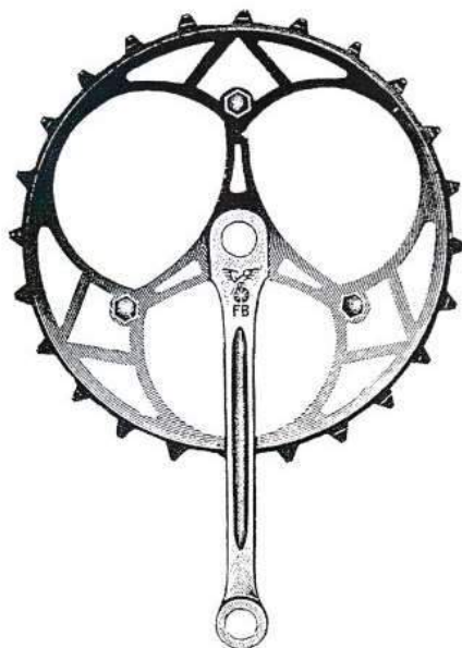
1970. Guarnitura F.B. a 3 bracci larghissimi da pista, 24 oppure 25 denti passo Humber 1'' \times 1/8 , cromata.
