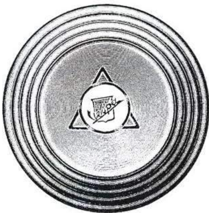
3614. Disco copriruota di scorta, in ottone cromato con contrassegno centrale, "Vespa" o "Lambretta".
