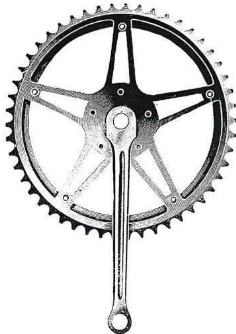
1978. Guarnitura A.M. a 5 viti a doppio ingranaggio denti 46 \times 49 , 1/2 \times 3/32 , cromata.
