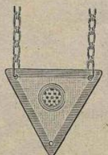
Grundplatte, weiß, 20 cm Seitenlänge und 15 mm breiter roter Rand Glas Ø 40 mm und 2 gleichlange Ketten 1544/1120
