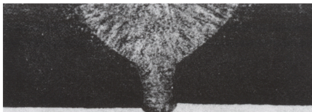
figuur 12.3 Doorsnede van een las gemaakt met het keyhole effect in 7 mm dik roestvast staal
