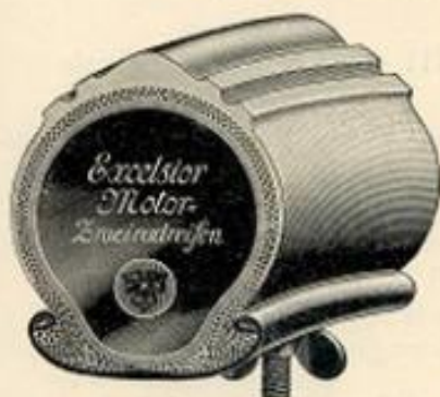
Sezione del pneumatico EXCELSIOR 1905 da motocicli per ruota anteriore permettente, per essendo antistruciolevole, una buona dirigibilità.
