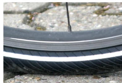
Zo moet het eruit zien. De band is onder het gewicht van de fietser nauwelijks vervormd.
