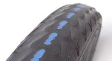
De anti-leklaag wordt zichtbaar. Deze band moet dringend vervangen worden.
