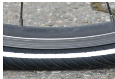
Zo moet het er niet uitzien. Hier is de bandenspanning veel te laag.
