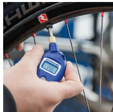
Het testen van de bandenspanning met de Airmax Pro.
