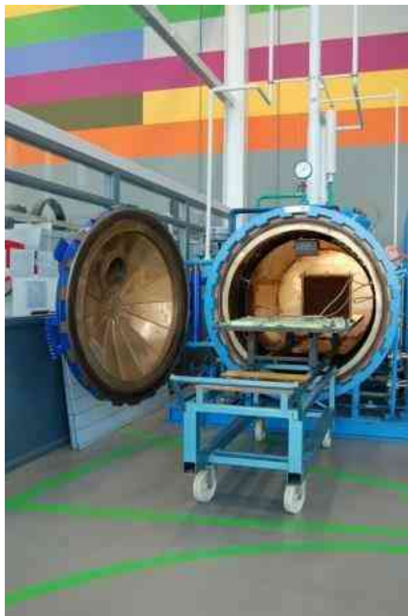
Figuur 25: Autoclaaf bij Composietenlab, INHolland, Delft
