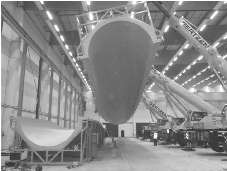
Figuur 17: Mal voor een 52m wind turbineblad (bron: Bright Composites)
