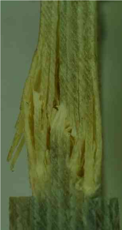
Figuur 28: Knik van lamellen en secundaire delaminatie
