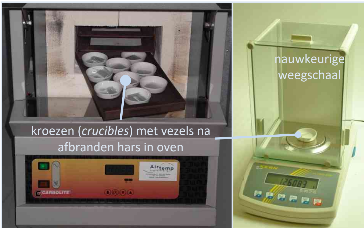
Figuur 68: Benodigdheden voor het doen van vezelvolumenmeting (bron: WMC)
