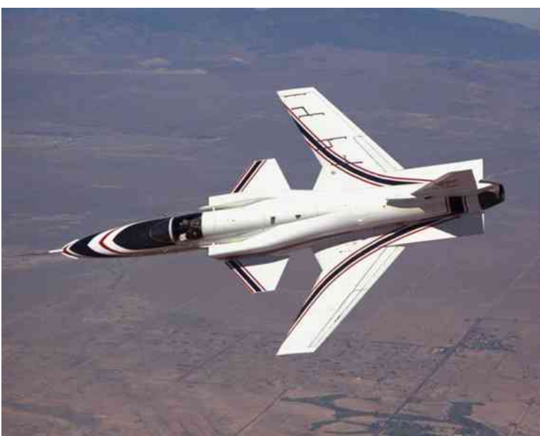
Figuur 36: Vliegtuig waarin koppelingseffect doelbewust is 'ingebouwd'
