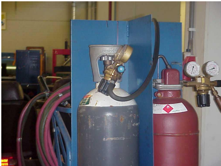
FIG. 2 Flessenwagen met zuurstof (links) en acetyleen (rechts).
